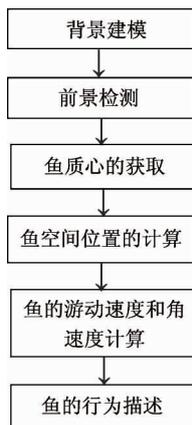
图 3 鱼类行为检测算法流程图
