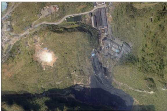
图3 贵州省铜仁市万山区万泰锰业尾矿库泄漏点无人机遥感影像
