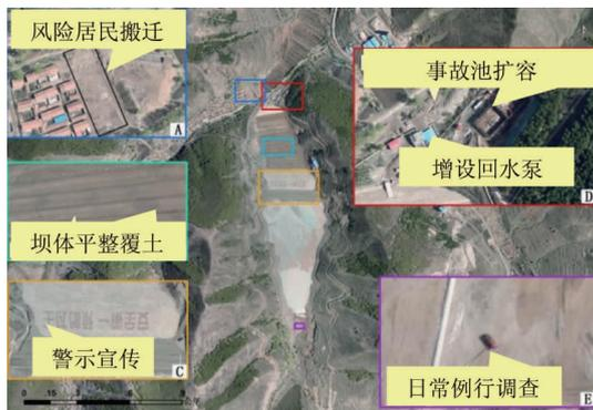
图6 尾矿库无人机遥感监测影像人机交互目视解译
