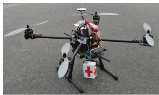
图 10 无人机挂载探测器
