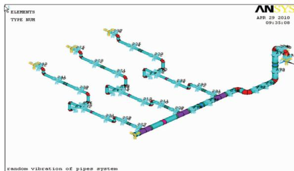
图 1 液压管路系统有限元模型
