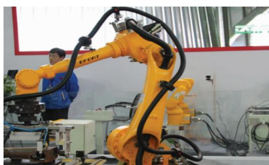
图 1 ER50-C20 打磨机器人现场示教图
