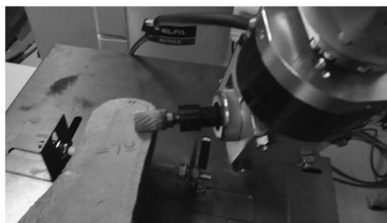
图 17 工业机器人鞋帮打磨实验
