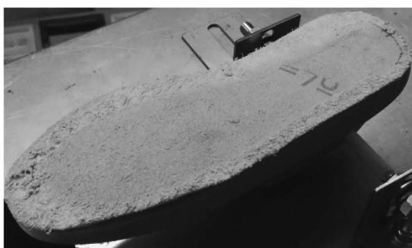
图 18 执行打磨程序后鞋帮底面的情况
