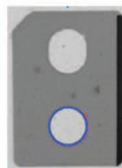
(a) 圆度不完整缺陷检测结果
