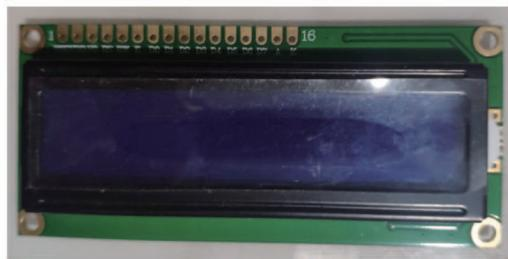
图 3 1602LCD 液晶显示屏
