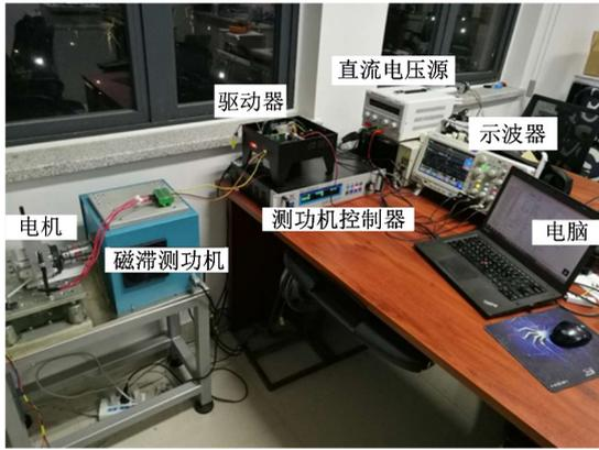
图 6 永磁同步电机驱动平台
