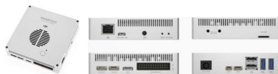
图 12 manifold 妙算微型计算机及其接口图
