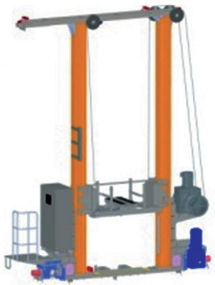
图 10 堆垛机示意图
