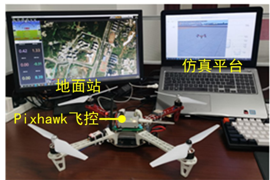
图 7 硬件在环无人机仿真系统实物
