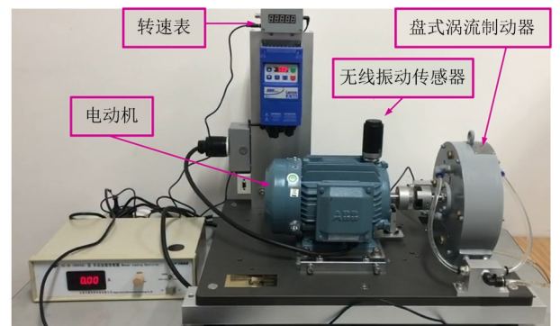
图3 滚动轴承故障测试实验平台
