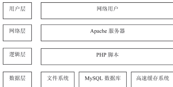
图 2 协作式知识创新服务平台的技术架构
